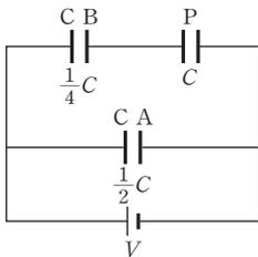
(가)에서 C와 B 사이의 전기 용량은  $\epsilon_0 \frac{S}{2d} = \frac{1}{4}C$ 이고, C와 B 사이의 축전기와 P는 직렬연결이므로 C와 B 사이에 걸리는 전압은  $\frac{4}{5}V$ 이다. 따라서 (가)에서 C와 B 사이에 충전된 전하량은  $\frac{1}{4}C \times \frac{4}{5}V = \frac{1}{5}CV$ 이다.
