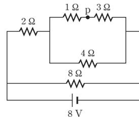
저항값이 각각 1  $\Omega$ , 3  $\Omega$ , 4  $\Omega$ 인 저항들의 합성 저항값은 2  $\Omega$ 이므로, 저항값이 2  $\Omega$ 인 저항에 걸리는 전압은 4 V이다.
