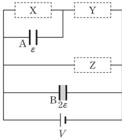
A에 저장된 전기 에너지가 최댓값을 가지기 위해서는 저항 X에 걸리는 전압이 최대이고 저항 Y에 걸리는 전압은 최소가 되어야 한다. 따라서 X에는 저항값이  $3R$ 인  $R_3$ 이 배치되어야 하고 Y에는 저항값이  $R$ 인  $R_1$ 이 배치되어야 한다. 따라서 A에 걸리는 전압은  $\frac{3}{4}V$ 가 되어 A에 저장된 전기 에너지의 최댓값은  $\frac{1}{2} \times C \times \left(\frac{3}{4}V\right)^2 = \frac{9}{32}CV^2 = \frac{9}{32}E$ 이다.
