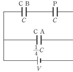
(나)에서 C와 B 사이의 전기 용량은  $2\epsilon_0 \frac{S}{d} = C$ 이고, C와 B 사이의 축전기와 P는 직렬연결이므로 P에 걸리는 전압은  $\frac{1}{2}V$ 이다. 따라서 (나)에서 P에 저장된 전기 에너지는  $\frac{1}{2} \times C \times \left(\frac{1}{2}V\right)^2 = \frac{1}{8}CV^2$ 이다.
